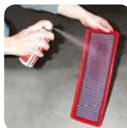
**6** Kit WA200-500. Le spray doit être placé à 15cm environ du filtre. Vaporiser complètement la surface de façon uniforme. répéter l'opération de l'autre coté du filtre.
