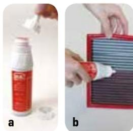
**5** Kit WA250-500. Retirer le bouchon. Percer la partie supérieure du cône distributeur et placer le sur le flacon. Passer sur chaque pli du filtre pour appliquer l'huile. Répéter l'opération deux fois de chaque coté de façon bien uniforme.
