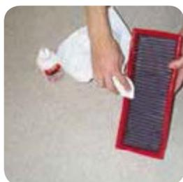
**7** Laisser le filtre en position à plat pendant au minimum 30 minutes pour que l'huile soit correctement absorbée par l'élément filtrant. Enlever les éventuels excès d'huile en bordure du caoutchouc avec un chiffon propre. Vérifier que votre filtre a une couleur homogène rouge. Si nécessaire, ajouter de l'huile aux endroits non imbibés. Votre filtre BMC est maintenant prêt à l'emploi et peut être installé à nouveau.
