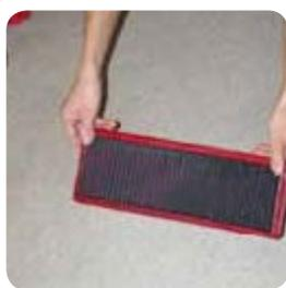
**1** Eliminer les poussières et particules apparentes en secouant le filtre.
