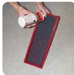
**2** Arroser votre filtre BMC en utilisant le flacon de détergent. Bien mouiller de façon uniforme et laisser agir 10 minutes.
